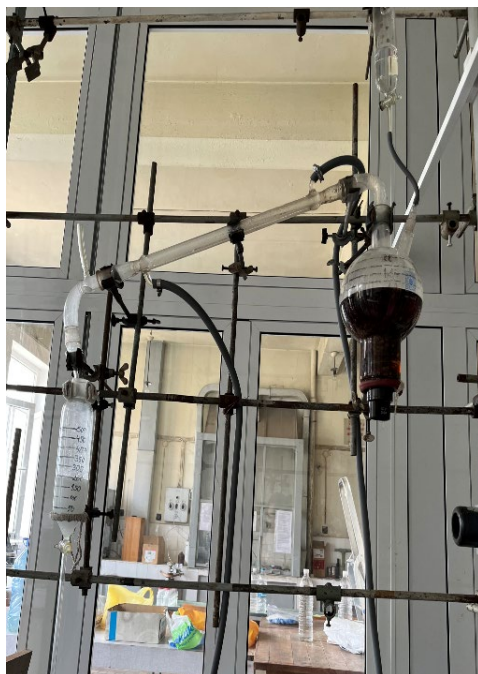
Фиг. 4 Снимка на опитна инсталация за получаване на етерично масло чрез хидродестилация. Първоначално 50g от карамфиловите пъпки се притеглят на електронна везна(KERN PCB).
