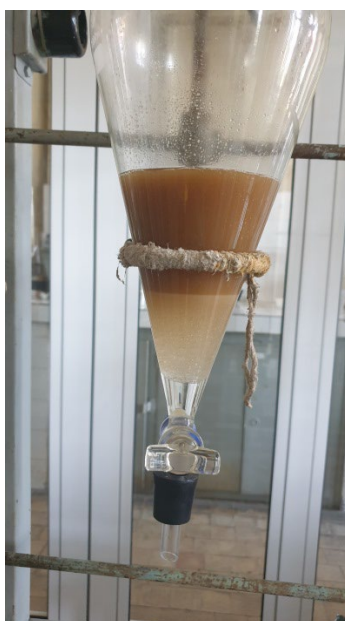
Фиг. 10 Разрушена трислойна емулсия.
